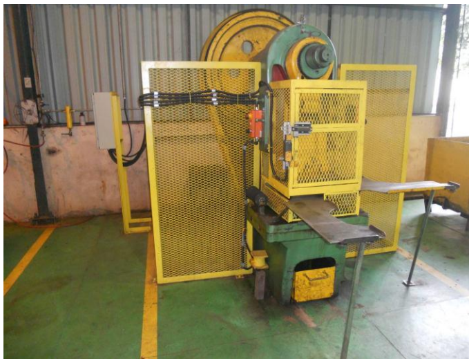
Figura 28: Estampadeira: vista geral com adequações de segurança Fonte: Arquivo pessoal, 2012
