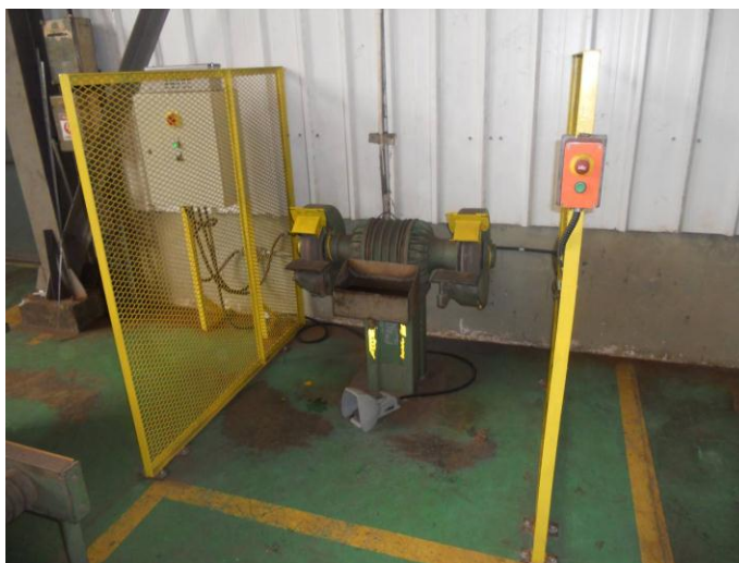
Figura 30: Esmeril: vista geral com adequações de segurança Fonte: Arquivo pessoal, 2012
