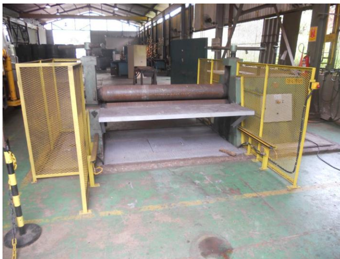
Figura 29: Calandra: vista geral com adequações de segurança Fonte: Arquivo pessoal, 2012
