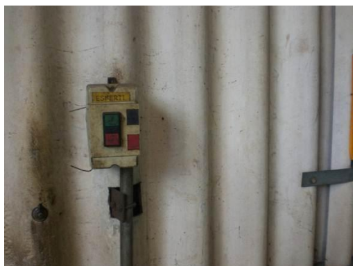
Figura 23: Esmeril: botões de acionamento Fonte: Arquivo pessoal, 2012
